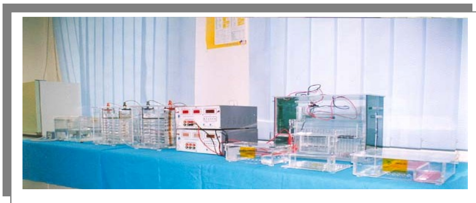
شکل ۹۲-۶- دستگاه الکتروفورز افقی مدل EPS-7601 و الکتروفورز عمودی مدل VEU-7305
