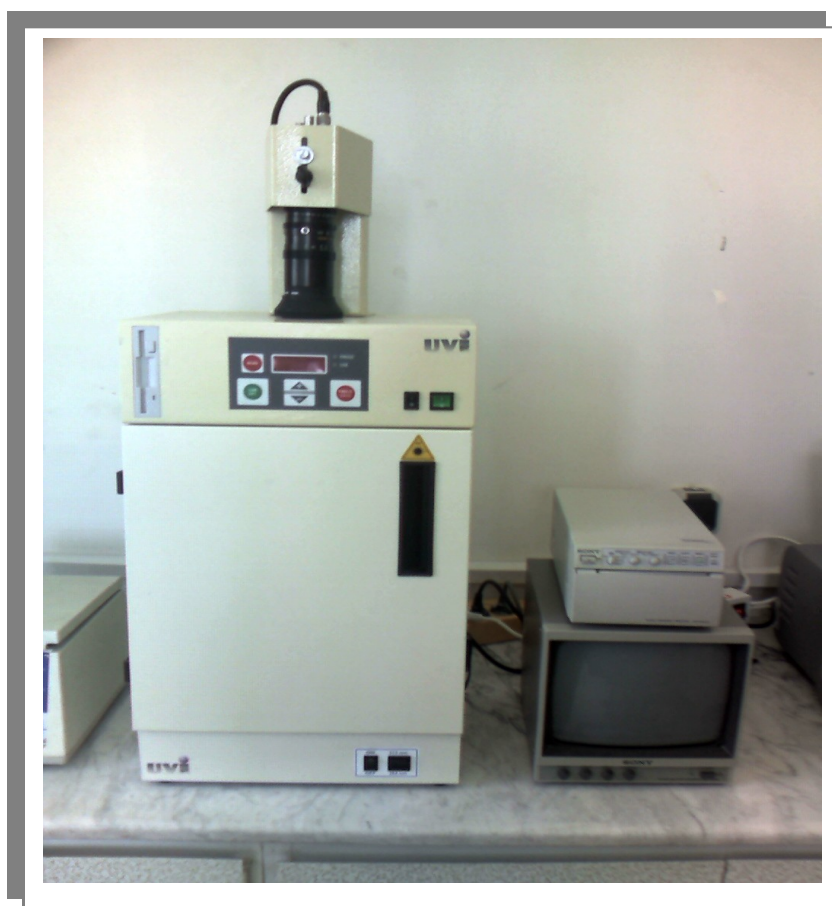
شکل ۸۸-۶- دستگاه مستند سازی ژل یا دستگاه ترانس ایلو میناتور مدل DOC-008.XD ساخت کمپانی UVI
