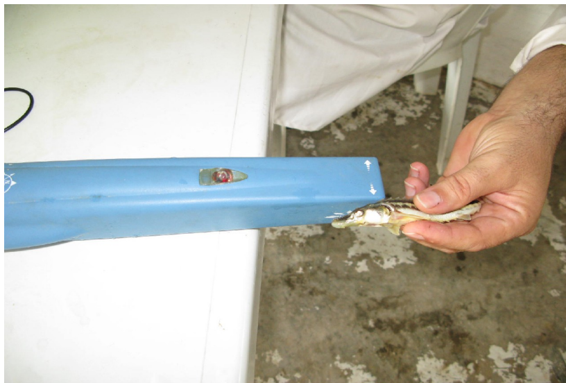
تصویر شماره ۷- روش کنترل صحت وجود تگ در بدن ماهی توسط دستگاه ردیاب مغناطیسی
