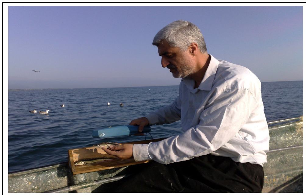
تصویر شماره ۸ - روش بررسی ماهیان واجد علامت توسط دستگاه ردیاب مغناطیسی
