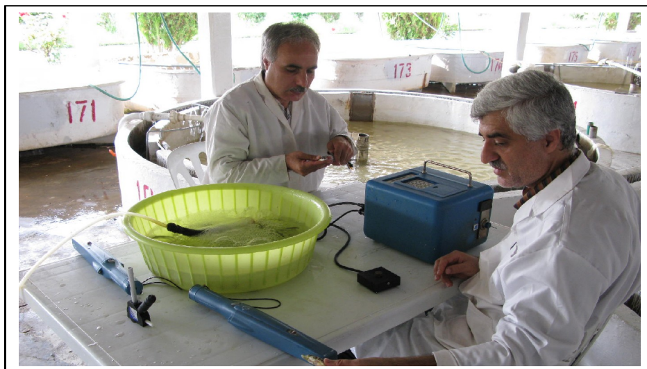
تصویر شماره ۶- روش کنترل صحت وجود تگ در بدن ماهی توسط دستگاه ردیاب مغناطیسی
