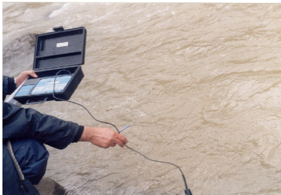
شکل ۴ : تعیین برخی از پارامترهای فیزیکوشیمیایی آب (O 2 , pH, Ec) بوسیله دستگاههای مربوطه
