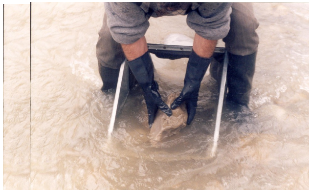
شکل ۵ : دستگاه نمونه برداری سوربر و چگونگی جمع آوری بیمهرگان کفزی
