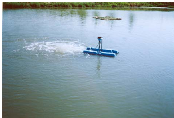
تصویرهای ۲۰ و ۲۱: هواده‌ی به استخرهای خاکی جهت کنترل شرایط زیستی
