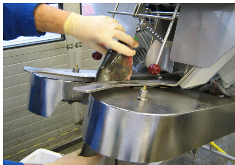
شکل (۱) ماشین سر زن مدل ۱۷۴۱
