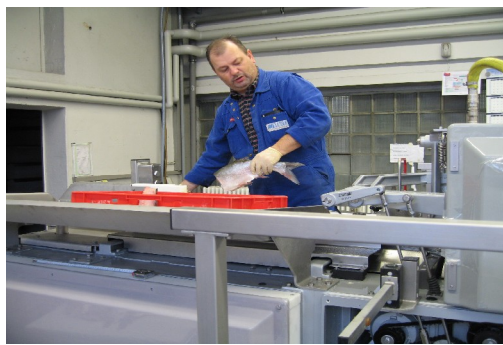
شکل (۲) ماشین فیله کنی ماهی مدل ۲۰۰
