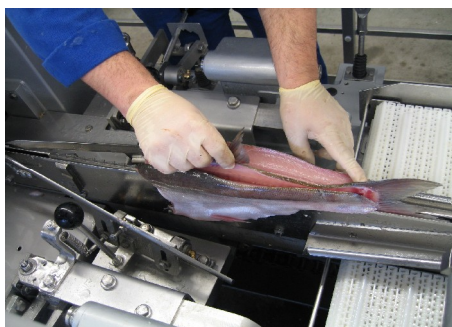
شکل (۴۷) روش فیله ماشینی
