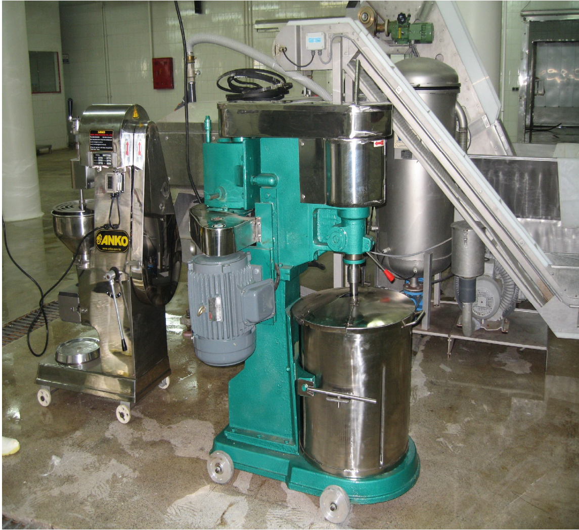
شکل ۸: دستگاه فرمینگ (قالب زن کوفته) و دستگاه میکسر (مخلوط کن) ساخت شرکت آنکو کشور تایوان
