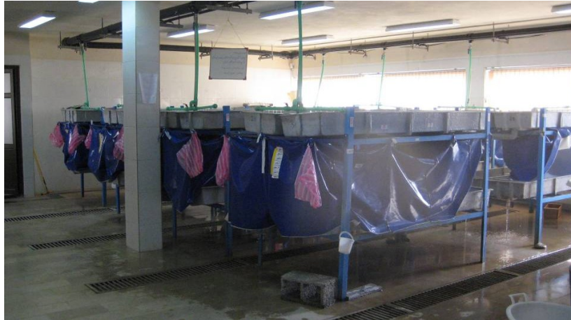
شکل (۷) - ترف های مورد استفاده برای نگهداری لاروها، مجهز به سیستم برق رسانی اتوماتیک و پوشش پرده ضخیم ضد آب
