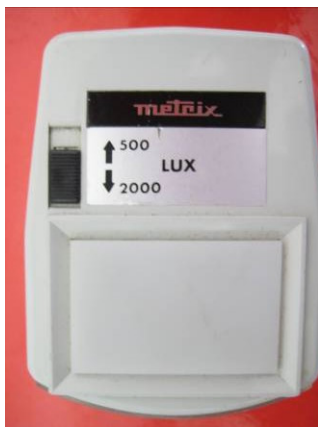
شکل ( ۱۱ ): دستگاه نورسنج ( مدل Metrix) مورد استفاده در تحقیق -
