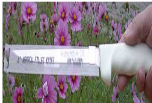
شکل ۹ - نمونه چاقو مخصوص تریمنگ دستی
