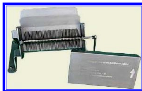
شکل ۶- دو نمونه دستگاه Pin-bone cutter مخصوص برش استخوان های ریز و سوزنی شکل (Dowgiallo, 2005)
