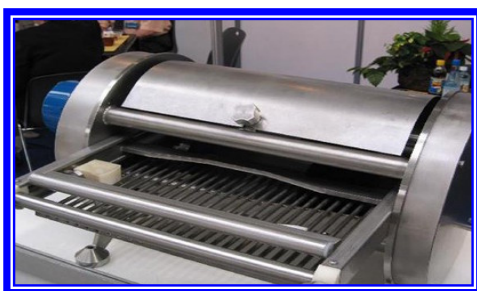
شکل ۶- دو نمونه دستگاه Pin-bone cutter مخصوص برش استخوان های ریز و سوزنی شکل (Dowgiallo, 2005)
