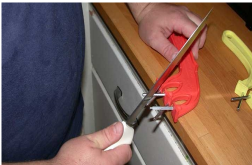
شکل ۱۰ - سوهان مخصوص تیز کردن چاقو
