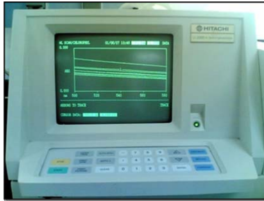
تصویر ۷- دستگاه اسپکترومتر جهت تهیه سوسپانسیون باکتریایی با تراکم نوری ۰/۱ در طول موج ۵۴۰ nm
