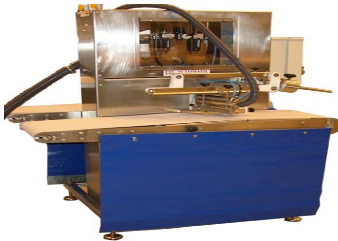
شکل ۲۰. دستگاه دو ریلی استخوان گیر سوزنی (دانمارکی)
