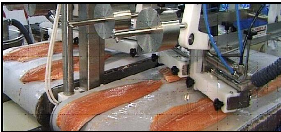
شکل ۱۵. دستگاه اتوماتیک استخوان گیر سوزنی برای گارگاههای بزرگ ( سوئدی )
