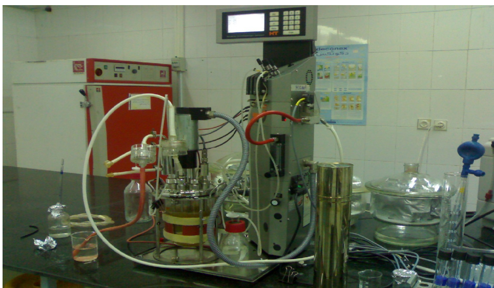
تصویر ۱: نمایی از فرمانتور CSTR و قسمتهای مختلف
