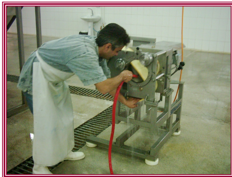
تصویر ۸- شستشوی ماشین آلات با آب گرم و مواد شوینده پیش از تولید
