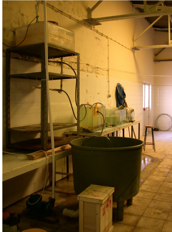
شکل ۱۳) سیستم طراحی شده برای سازگاری نمونه‌ها متشکل از پمپ، مخزن آب، آکواریوم خوگیری و اتصالات مربوطه (اخذ شده از Ward, 1974)
