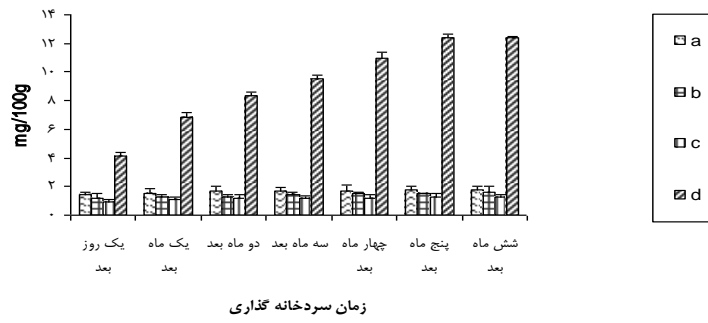
شکل ۵. تغییرات اسید چرب آزاد نمونه های پوشش دار با شاهد طی زمان نگهداری در سردخانه به مدت شش ماه a: نمونه های پوشش شده زمان صفر ، b : نمونه های پوشش شده به مدت زمان ۲ ساعت، c : نمونه های پوشش شده به مدت زمان ۴ ساعت، d : نمونه های شاهد
