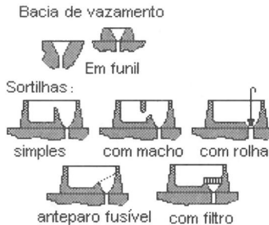
Figura 62 - Diferentes tipos de bacias de vazamento [3].
