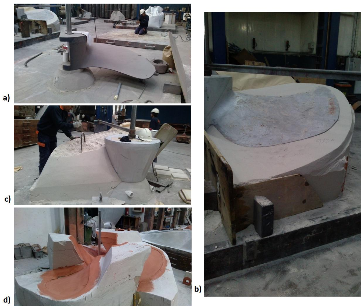
Figura 12 - Moldação de uma hélice de passo fixo: a) modelo da pá; b) moldação inferior; c) moldação superior; d) moldação inferior pintada com tinta refratária.
