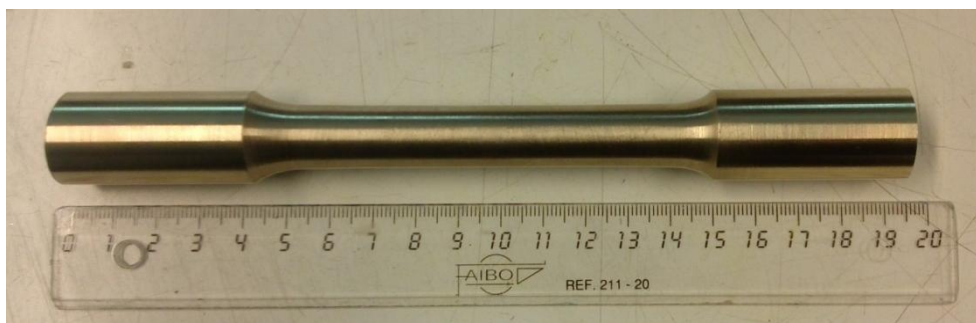
Figura 73 - Proвете normalizado EN ISO 6892-1 de liga CU3.
