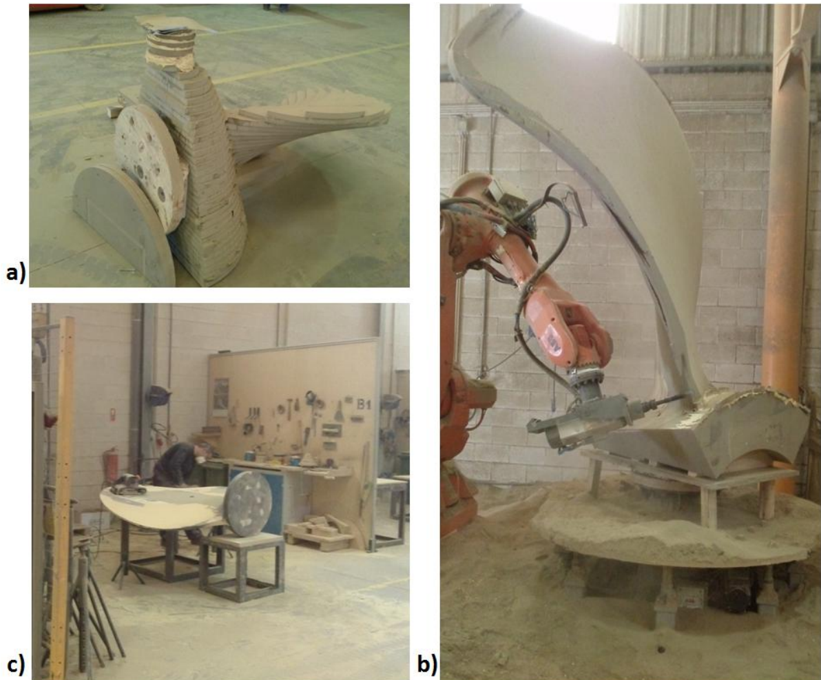
Figura 10 - Modelos em madeira fabricados na Fundilusa: a) sobreposição de camadas de madeira; b) maquinação do modelo num robô CNC; c) processo de acabamento do modelo em madeira.
