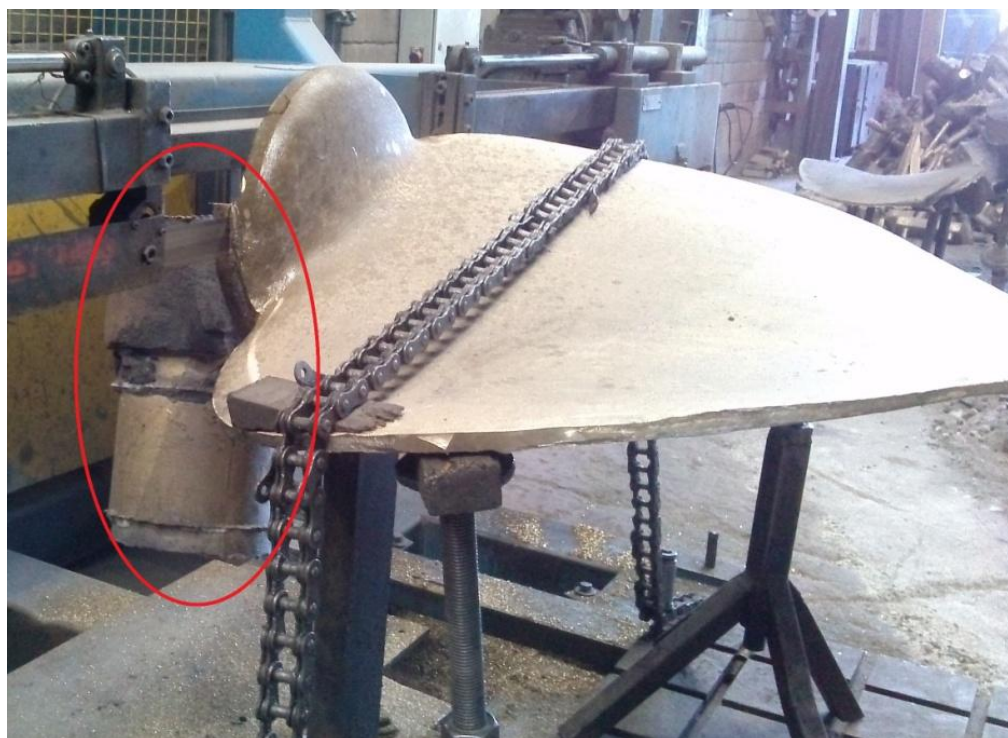
Figura 80 - Alimentador atmosférico cilíndrico lateral.
