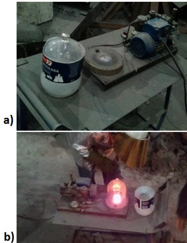
Figura 41 - Teste de pressão reduzida realizado na Fundilusa: a) máquina de testes; b) realização do teste de pressão reduzida.
