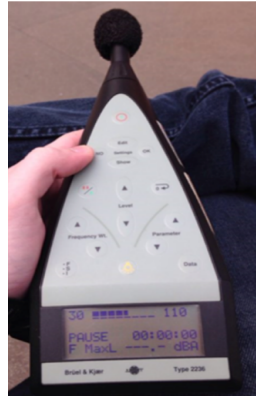
Fig. 5.1 – Sonómetro do tipo 2236 da empresa B&K [foto do autor].
