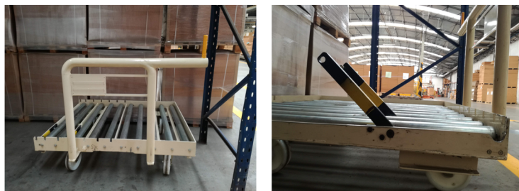
Figura C.2: Componentes do carro com as alterações feitas, do lado direito, o batente e, do lado esquerdo, os travões.
