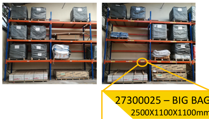
Figura G.2: Exemplo de identificação dos artigos, com o código e a descrição.
