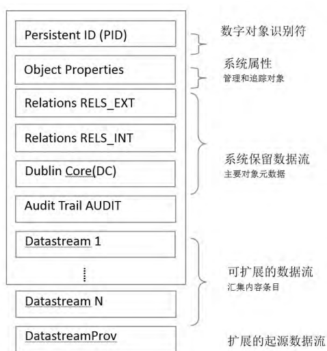
图 4 FOXML 结构示意图
