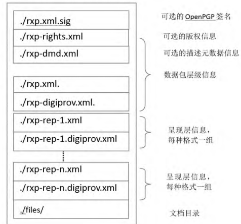
图 3 RXP 结构示意图
