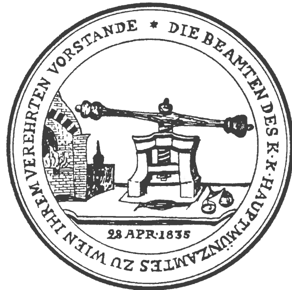
Abb. 2: Darstellung einer Münzpresse aus der ersten Hälfte des 19. Jahrhunderts, wie sie vermutlich auch für die Verdichtung des Platinschwamms gedient hat.
