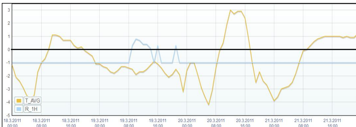
Bild 28. Medeltemperaturen vid två meters höjd ( T_{AVG} ) och en timmes nederbördsmängd ( R_{1H} ) som funktion av tiden mellan den 18 mars till den 21 mars 2011 i Kajaniemi. R_{1H} har värdet -1 då nederbördsmängden under den senaste timmen är 0 mm. Källa: FMI
