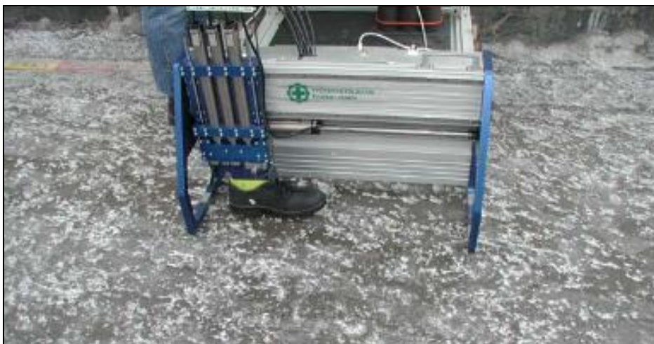
Bild 9. Flyttbar halkmätare, utvecklad av Arbetshälsoinstitutet. (Aschan et al., 2004)
