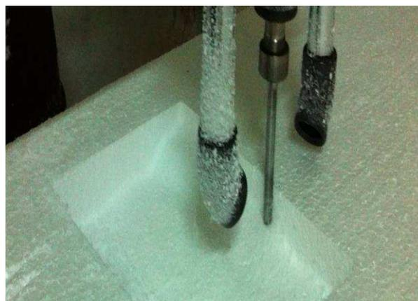
Figura 6. Detalle del proceso de impresión 3D sobre plancha de poliestireno expandido.
