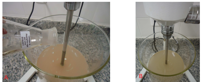
Figura 3. (A) Adição da solução de celulase; (B) Agitação do gel de galactomananas durante o processo de hidrólise
