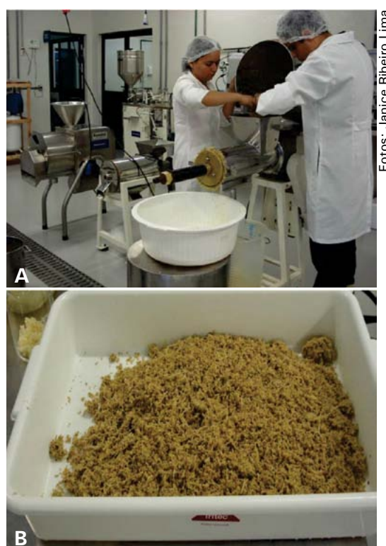
Figura 2. Prensagem do bagaço do caju (A) e fibra tratada (B).
