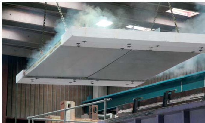
Obr. 10 První série úspěšných zkoušek požární odolnosti ■ Fig. 10 The first series of successfully passed fire certification testing.
