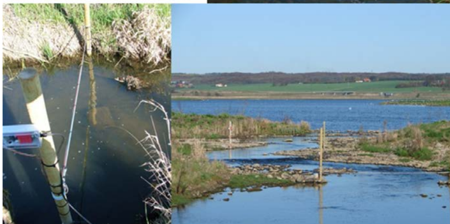
Figur 5. Antennerne ved indløbet til Egå Engsø (til højre) og udløbet (nedenfor). I nederste venstre hjørne er et nærbillede af en antenne. Bemærk styrtet umiddelbart efter opstrømsantennen til venstre, som reducerer opstuvning i grødesæsonen, hvilket er godt for kvaliteten af vandføringsdata, se teksten for nærmere forklaring. Der var cirka 1.400 meter mellem de to antennestationer.
