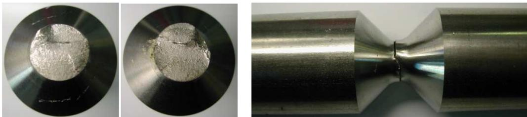
Figura F.3.2 Superfici di frattura e vista laterale per il provino Traz\_r3mm\_R-1\_03
