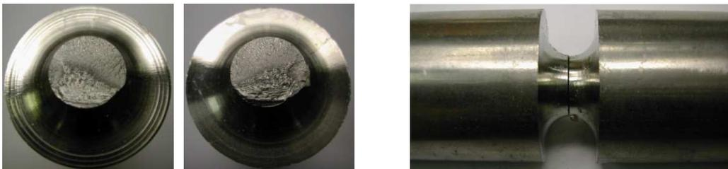
Figura E.10.2 Superfici di frattura e vista laterale per il provino Traz\_r5mm\_R-1\_10
