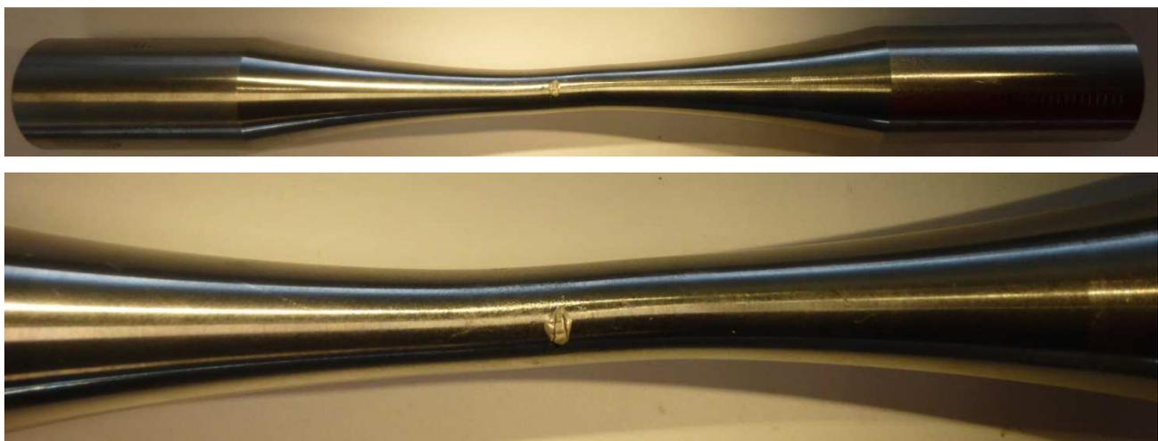
Figura H.2.5 Dettaglio della luce libera ad inflessione per il provino Traz\_liscio\_R-2\_02
