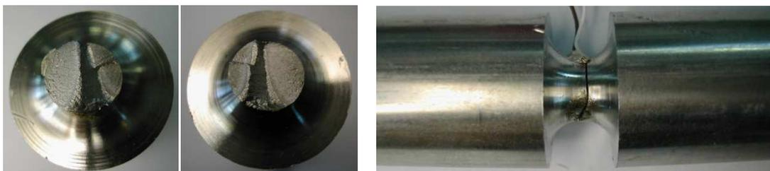
Figura E.3.2 Superfici di frattura e vista laterale per il provino Traz\_r5mm\_R-1\_03
