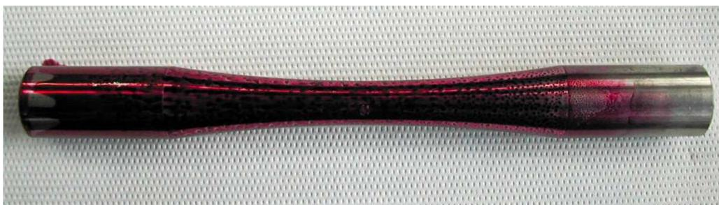
Figura 3.4: Aspetto del provino a seguito dell'attesa del tempo di penetrazione del liquido penetrante
