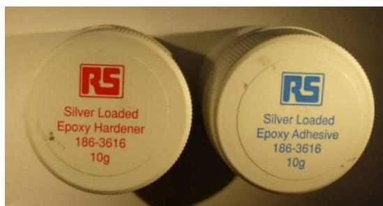
**Figura 5.37: Colla epossidica conduttiva caricata con argento (a destra l'adesivo e a sinistra l'indurente)**
