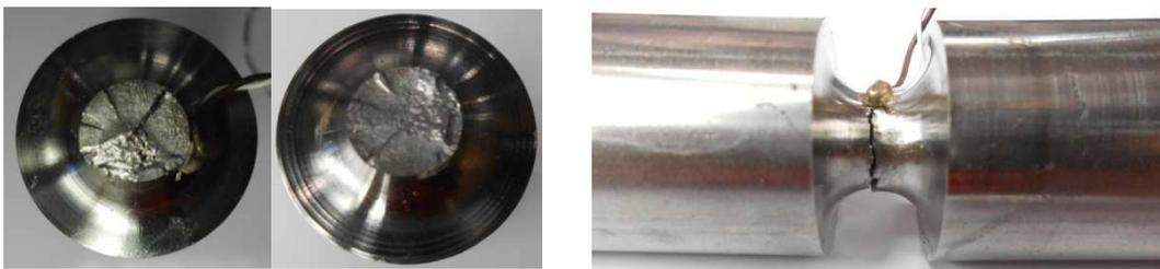
Figura E.7.2 Superfici di frattura e vista laterale per il provino Traz\_r5mm\_R-1\_07
