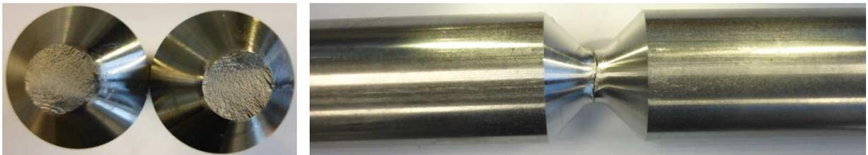
Figura F.11.3 Superfici di frattura e vista laterale per il provino Traz\_r3mm\_R-1\_11
