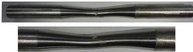
Figura I.1.4 Dettaglio della luce libera ad inflessione per il provino Traz\_liscio\_R-1.5\_01
