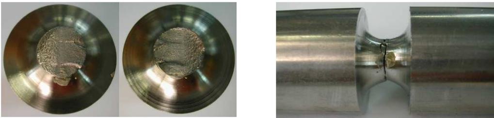
Figura E.8.2 Superfici di frattura e vista laterale per il provino Traz\_r5mm\_R-1\_08
