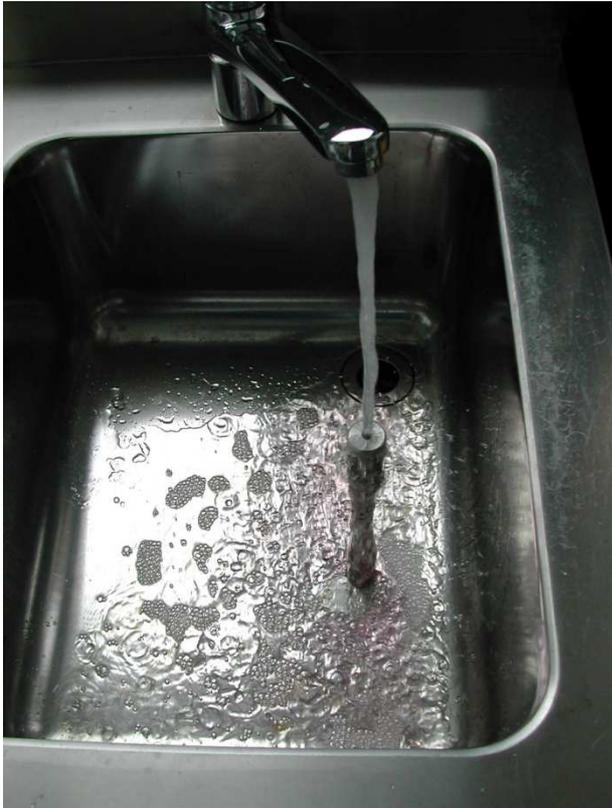
Figura 3.5: Asportazione del penetrante dal provino tramite lavaggio con acqua a temperatura ambiente.
