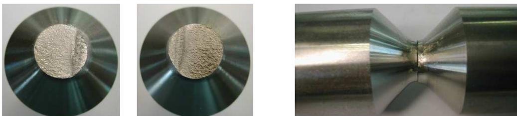
Figura F.5.2 Superfici di frattura e vista laterale per il provino Traz\_r3mm\_R-1\_05
