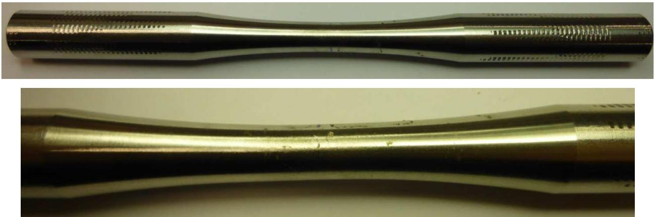
Figura H.4.2 Dettaglio della luce libera ad inflessione per il provino Traz\_liscio\_R-2\_04
