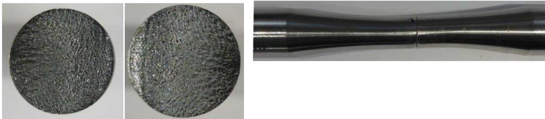
Figura I.5.2 Superfici di frattura e vista laterale per il provino Traz\_liscio\_R-1.5\_05
