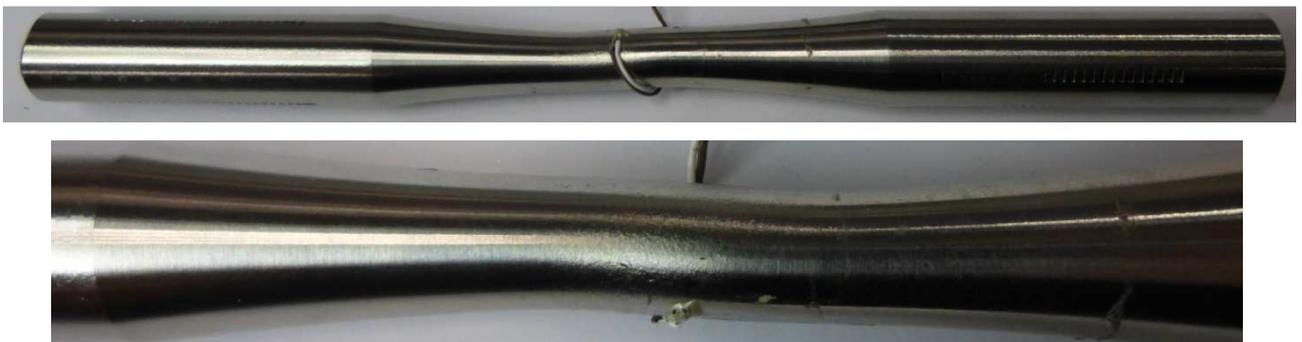
Figura I.1.4 Dettaglio della luce libera ad inflessione per il provino Traz\_liscio\_R-1.5\_01
