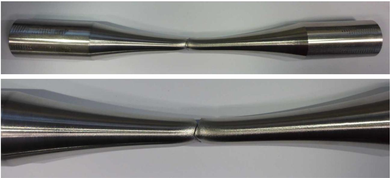
**Figura A.21.4** Dettaglio superfici di frattura e vista laterale per il provino Traz\_liscio\_R0.1\_21
