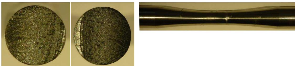
Figura I.2.5 Superfici di frattura e vista laterale per il provino Traz\_liscio\_R-1.5\_02
