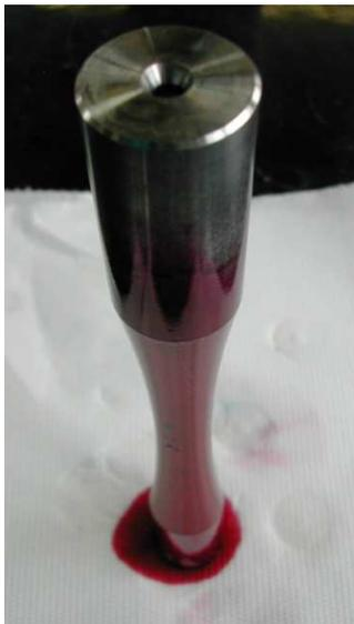
**Figura 3.3:**Aspetto del provino subito dopo l'applicazione del penetrante
