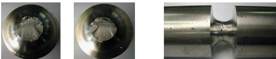
Figura E.1.2 Vista frontale e vista laterale delle superfici di frattura per il provino Traz\_r5mm\_R-1\_01
