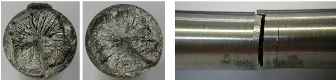
Figura D.9.2 Vista frontale e laterale delle superfici di frattura per il provino Torq\_liscio\_R-1\_09
