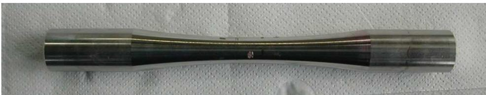
Figura 3.6: Provino a seguito del lavaggio con acqua e della successiva asciugatura
