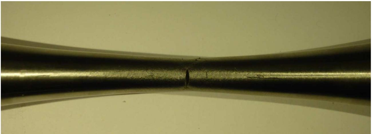
Figura A.20.4 Superfici di frattura e vista laterale per il provino Traz\_liscio\_R0.1\_20
