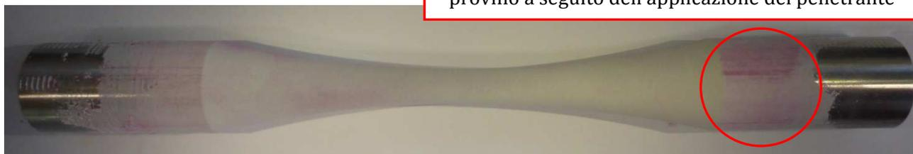
Figura 3.8: Provino a cui è stato applicato il rilevatore bianco e che non presenta alcun segnale di danneggiamento superficiale
