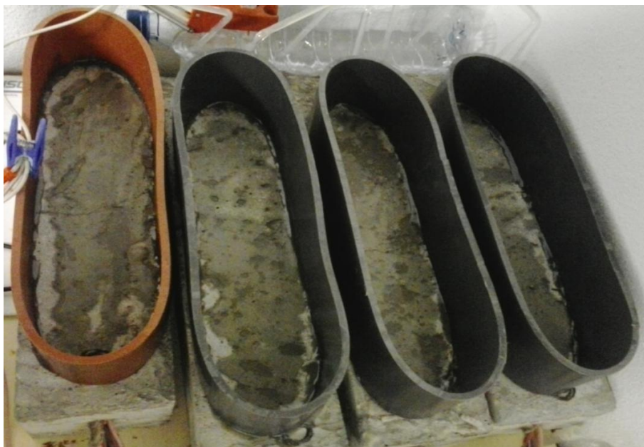
Figura 3.2 - Fotografia dos quatro prismas utilizados no estudo da avaliação do comportamento dos pares de aço não ligado/ aço inoxidável em condições diferenciais promovidas pela fissuração do betão.
