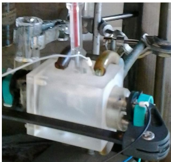
Figura 3.4 - Fotografia da célula eletroquímica utilizada nos estudos em solução.
