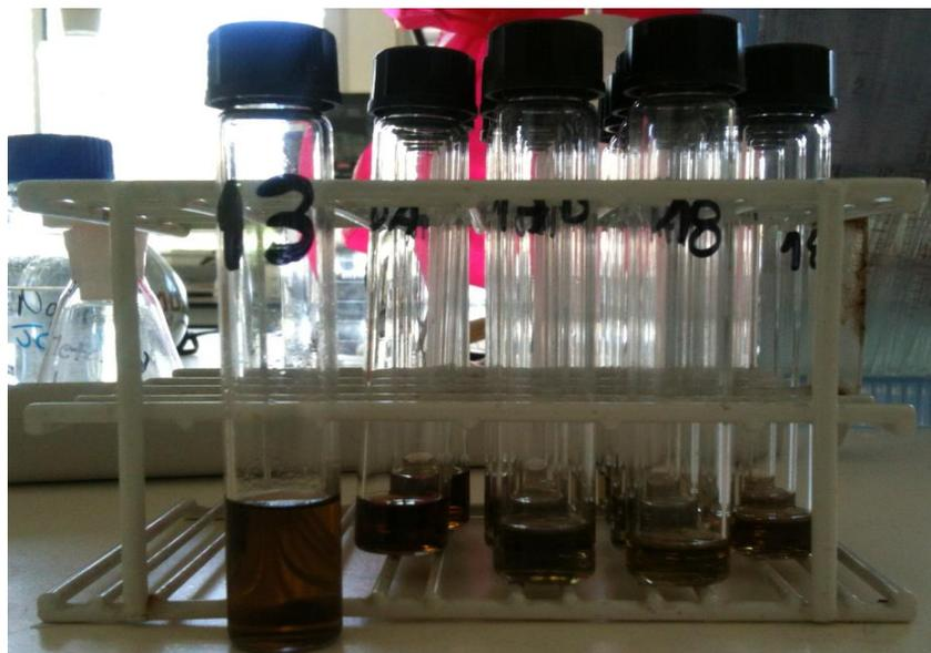
Figura 3.16 - Volume de fase do clorofórmio, obtida após retirar os 3,5ml necessários para preparação da amostra para cromatografia (13 – reacção com etanol; outros - reacção com metanol)
