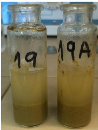
Figura 3.14 - Fase final de separação dos ésteres com clorofórmio no ensaio de esterificação / transesterificação com biomassa húmida.
