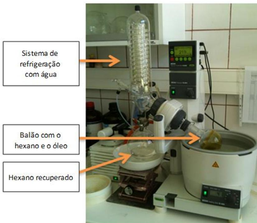
Figura 2.6 – Rotavapor para evaporação do solvente
