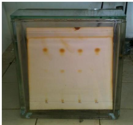
Figura 2.10 – Revelação da placa de cromatografia na câmara de iodo
