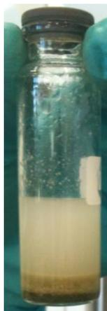
Figura 2.9 – Estratificação das fases, após adição de clorofórmio e água à mistura reacional
