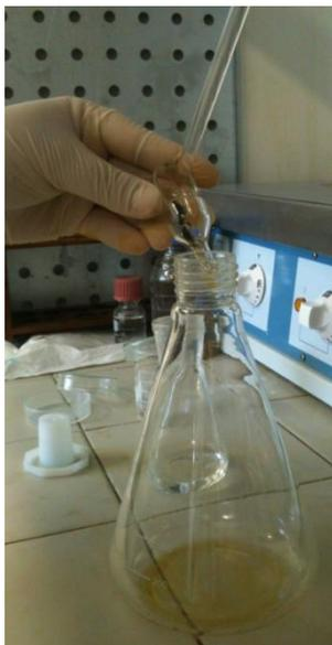
Figura 2.7 – Processo de transferência da amostra para o frasco *Erlenmeyer* na determinação do índice de iodo
