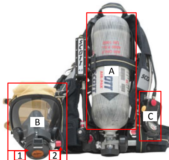
Figura 2.2 – Aparelho Respiratório Isolado de Circuito Aberto (ARICA) é composto por uma garrafa de ar comprimido (A), uma peça facial (B) que contém duas válvulas (1 e 2) e um manómetro (C). (Figura adaptada de [11]).
