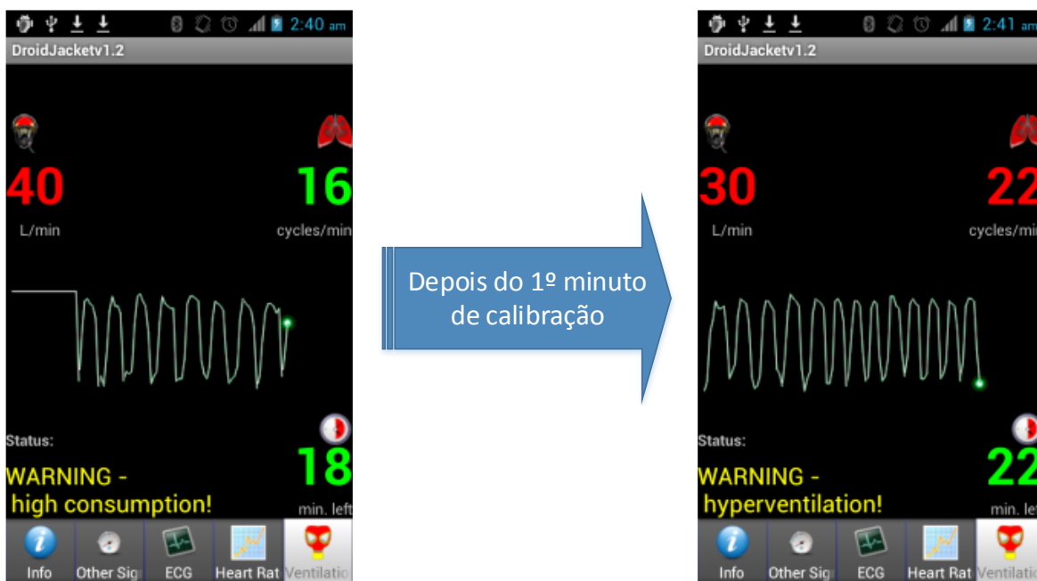
Figura 4.10 - Ilustração do funcionamento da monitorização Respiratória: I) monitorização durante o 1º minuto em é usada a estimativa de consumo por defeito; II) monitorização depois de adquirido o consumo do 1º minuto, e sua repercussão na estimativa de autonomia
