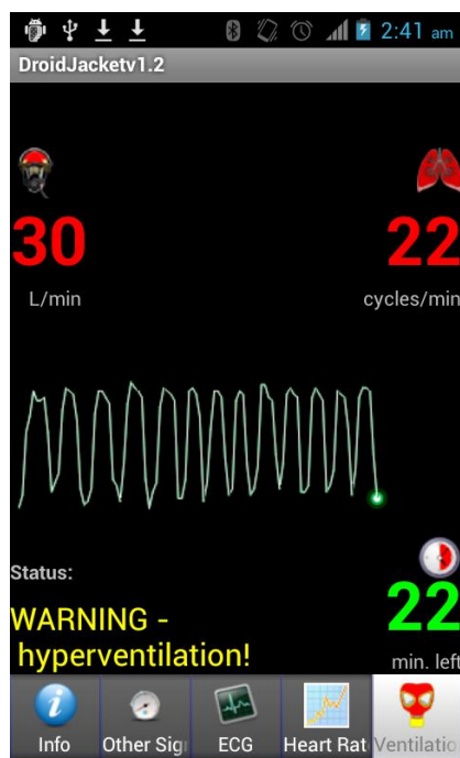
Figura 4.6 - Interface de monitorização respiratória - apresentando frequência respiratória (canto superior direito), consumo (canto superior esquerdo), autonomia (canto inferior direito), estado global do operador (canto inferior esquerdo) e desenho gráfico do sinal (centro).
