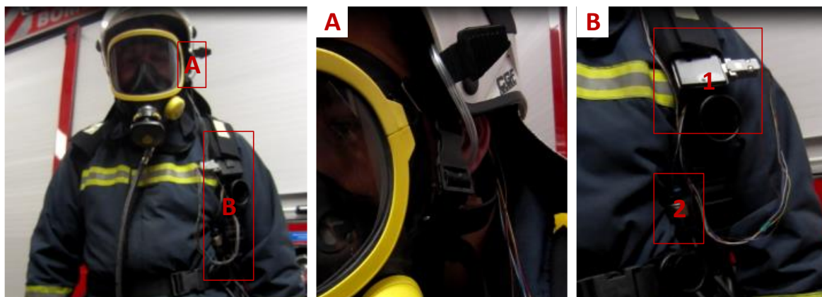
Figura 5.1 - Bombeiro equipado com VitalAir : A – módulo do capacete; B1 – unidade de processamento; B2 – sensor de pressão da garrafa
