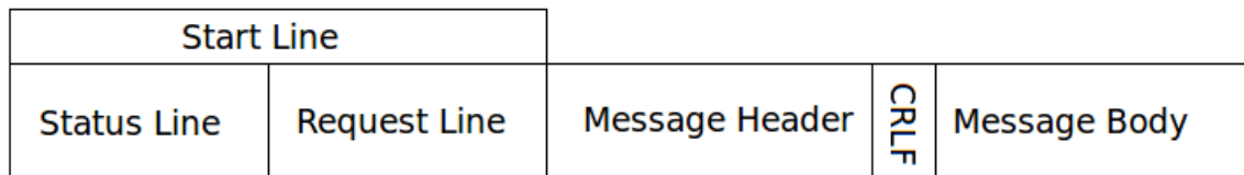
Figura 2.4: Estrutura da mensagem SIP
