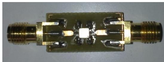
Figura 57 - Fotografia da camada superior da placa do filtro passa banda.
