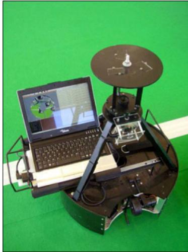
Figura 3.1: Detalhe da unidade de processamento principal presente em cada robô da equipa CAMBADA (fonte: [Nev+10a]).
