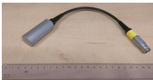
Figure 2: 500 mm 3 CZT detector.
