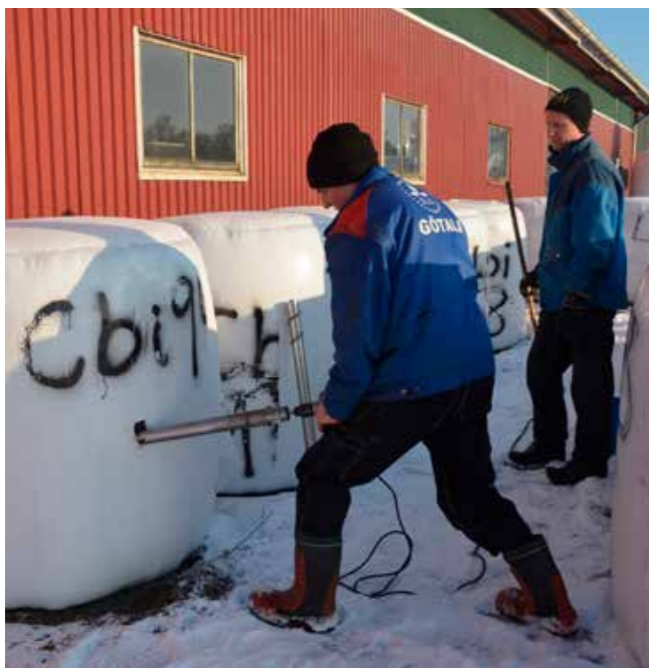
Ensilageprov ur rundbal tas genom borrhning.
