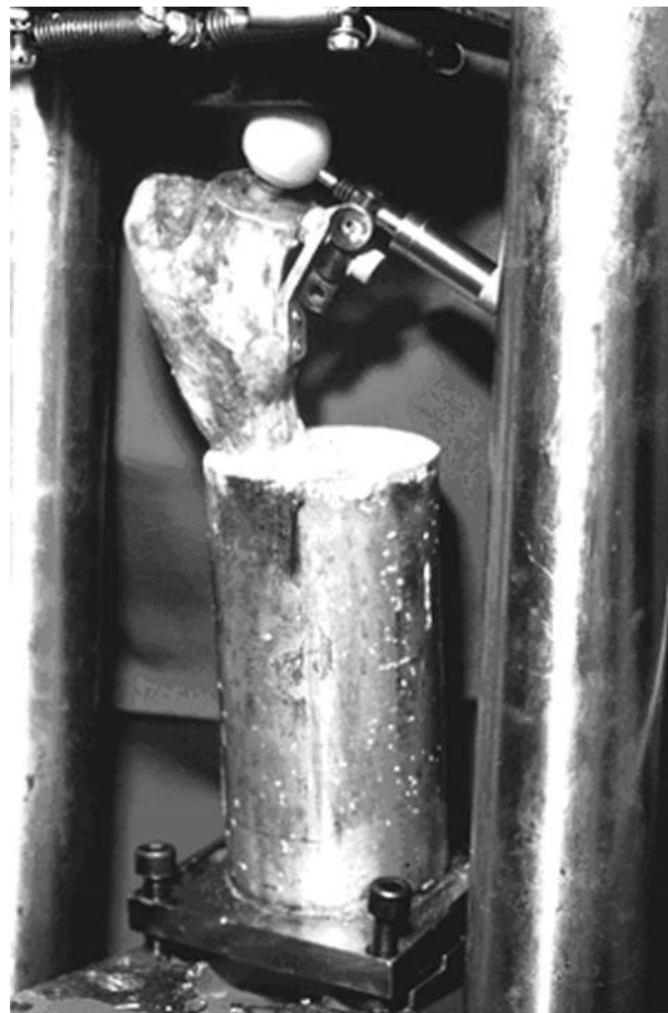
Abbildung 4 Versuchsaufbau in Antetorsionsstellung mit Wegaufnehmer.
