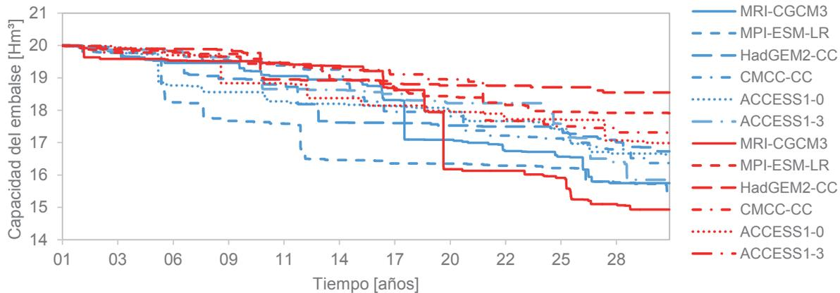
**Figura 10** | Curva simulada de disminución de capacidad del embalse de M<sup>a</sup>. Cristina, dentro de la cuenca de la Rambla de la Viuda para los escenarios climáticos corregidos en el período de Control (líneas azules) y Futuro (líneas rojas).
