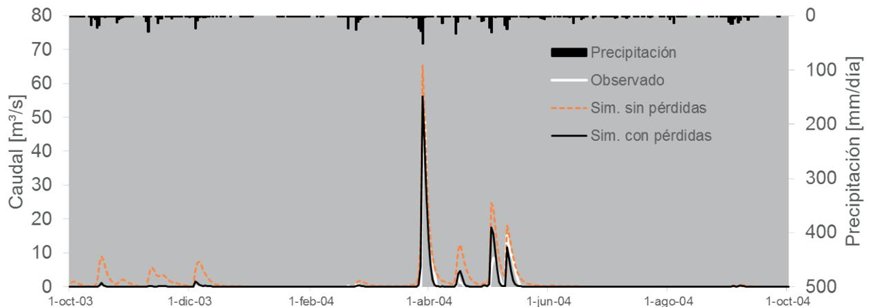
**Figura 4 |** Hidrogramas observado y simulados en el periodo de calibración (2003-2004) en el embalse de M<sup>a</sup>. Cristina de la cuenca de la Rambla de la Viuda.
