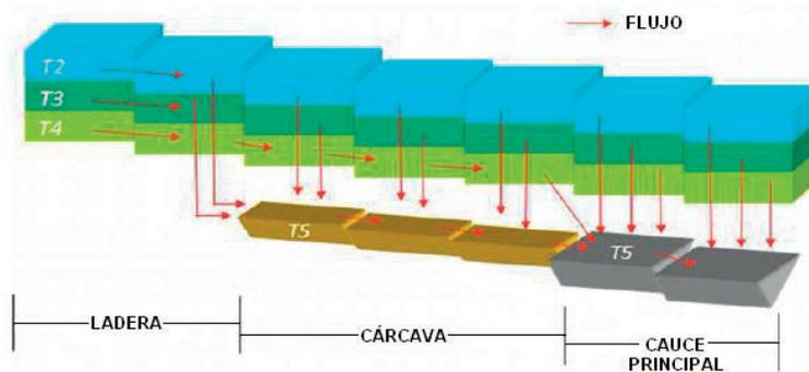
Figura 3 | Movimiento horizontal propuesto por el modelo TETIS (simplificación 2D).
