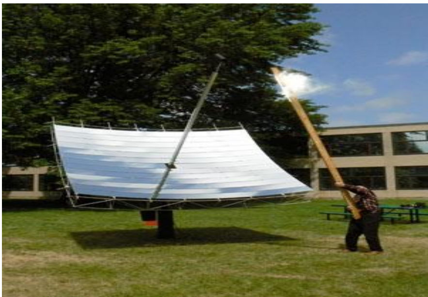
Figure 2.9: Parabolic solar collector by MIT students (Source: MIT news)
