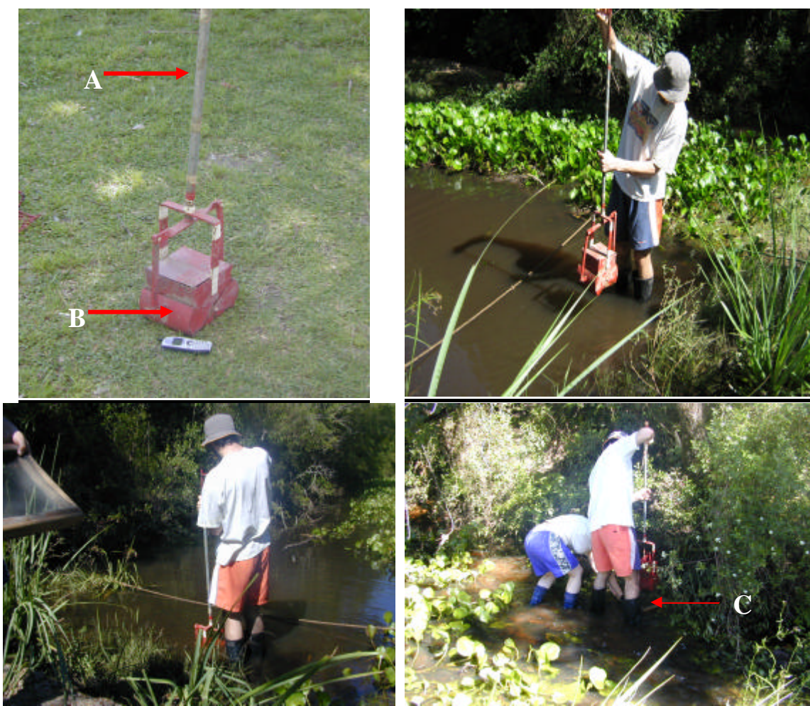
Figura 9. Colecta con una draga tipo Ekman, sin mensajero, con un eje metálico (A) que cumple la función de cerrar las palas (B) en el sedimento. Este sedimento se vuelca en un tamiz (C) de 1 mm de abertura de malla
