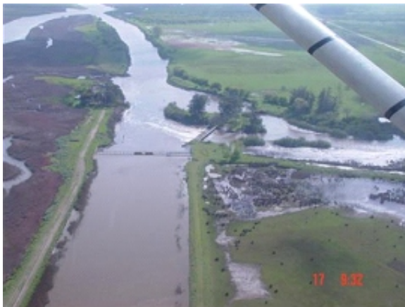
Fotos N° 3 y N° 4: Inundaciones en el partido de Gral. Lavalle, Pcia. de Buenos Aires (R. Argentina). Obras de control (izq.) inefectivas y canales secundarios colmatados por sedimentos y vegetación palustre (der.) (Fotos: PR; RS, UNLP, 2002).
