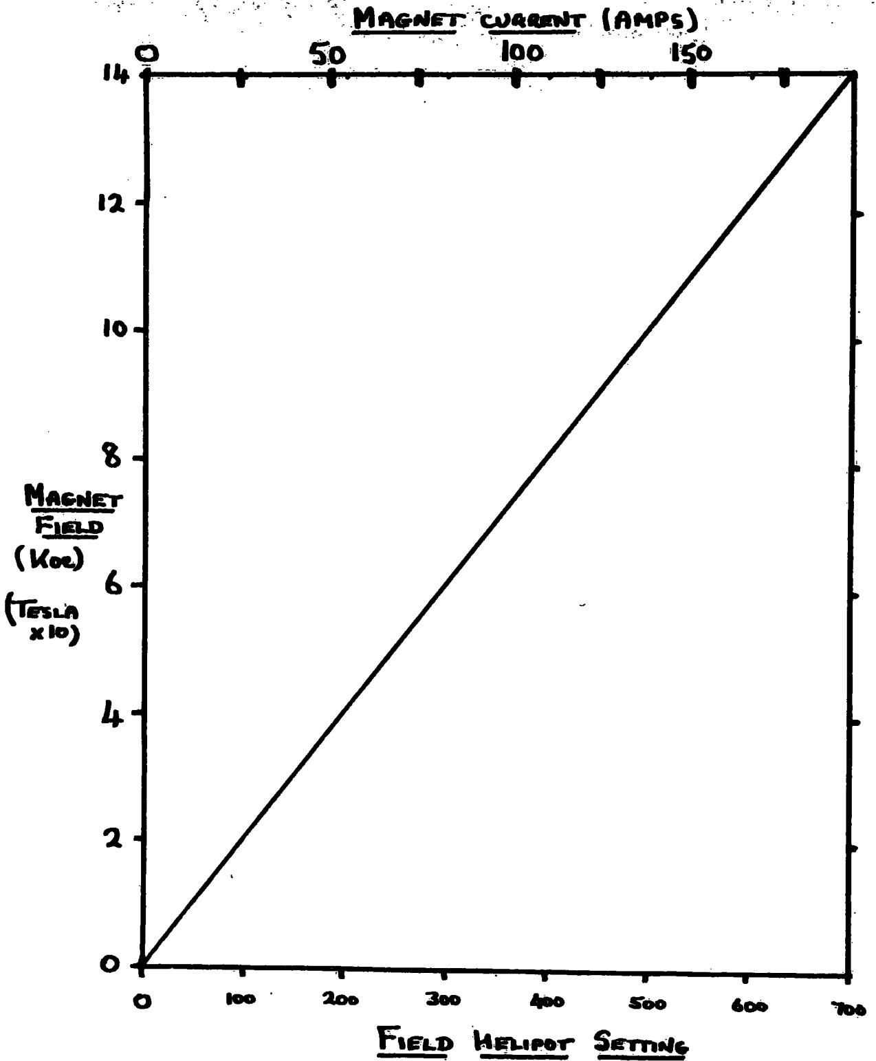
FIG. 4.3.18. MAGNET CALIBRATION.
