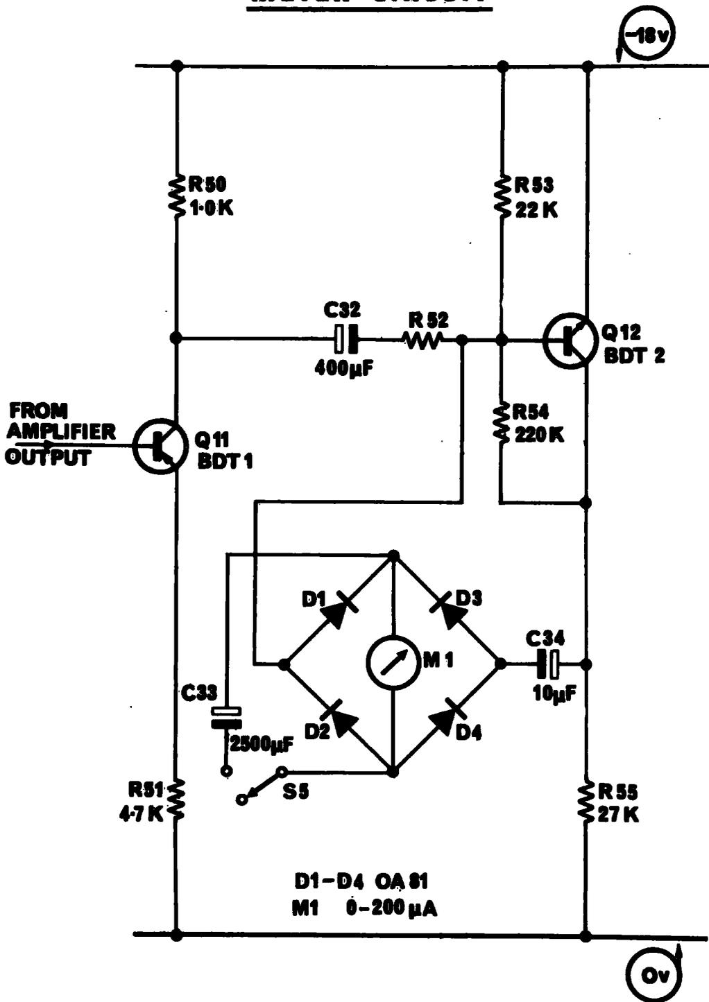
Fig. A1.2 LNA. METER CIRCUIT.
