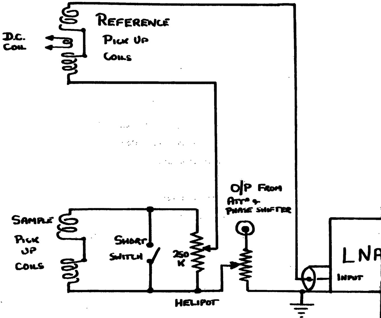
FIG. 4.3.11. L.N.A. INPUT CIRCUIT.
