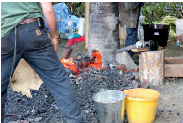
Fig. 12. Reducción experimental de mineral de hierro en un horno de chimenea ventilado con una tobera. Extracción de la lupia. Obsérvese la importante cantidad de material (carbones, mineral, escoria) extraído del horno junto con la lupia. Experimento realizado en West Dean College, Chichester (Inglaterra) en 2010, durante un encuentro de Arqueometalurgia experimental (en color en la edición electrónica).
