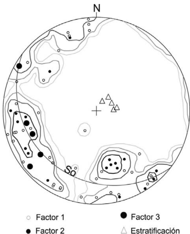
Figura 7.- Proyección estereográfica de las diaclasas y la estratificación en la zona de los deslizamientos. Planos de diaclasas medidos, 64. Las líneas de isodensidad corresponden a 8, 4, 2, 1%. S 0 : ciclográfica del plano medio de estratificación.
