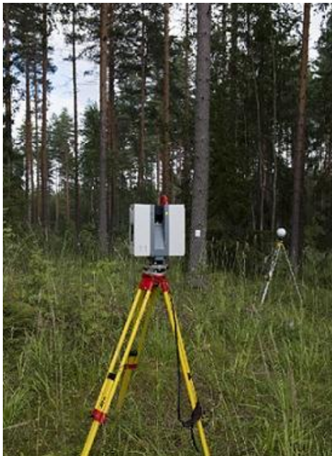
Kuva 6. Leimikon maastolaserkeilaus toteutettiin Leica HDS6100 keilaimella. Kuva: Ville Kankare.
