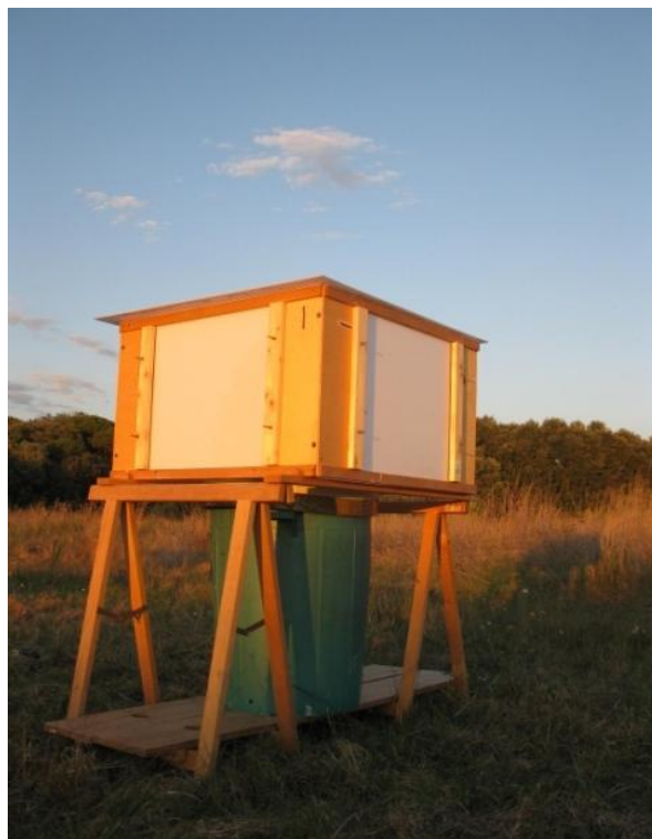
Figura 2.8 Apparato sperimentale costituito da imbuto di Emlen e arena di legno provvista di pannelli di plexiglass
