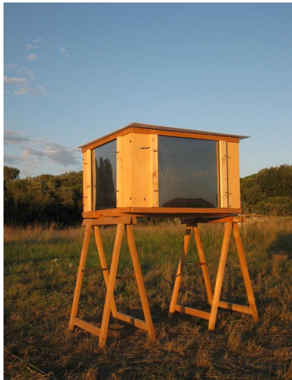
Figura 2.11 Gabbia di esposizione utilizzata per manipolare il pattern di luce polarizzata
