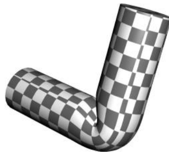
Figura 1.11: perdita di volume dovuta ad un piegamento eccessivo ( collapsing elbow ).
