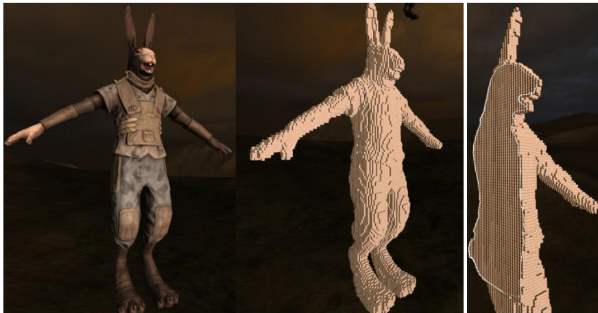
Figura 2.9: la mesh viene approssimata tramite una serie di cubi di dimensione identica che riempiono completamente il volume (voxellizzazione).
