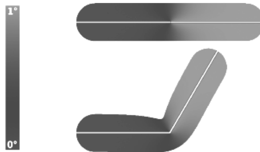
Figura 2.8: la figura sopra rappresenta l'equilibrio del calore per due bones; la figura sotto mostra i risultati dopo una deformazione.
