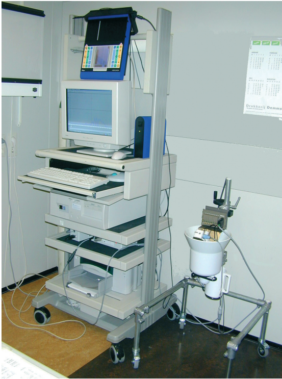
Fig. 19. Complete meetopstelling voor de niet invasieve condoommethode om de blaasdruk te meten.
