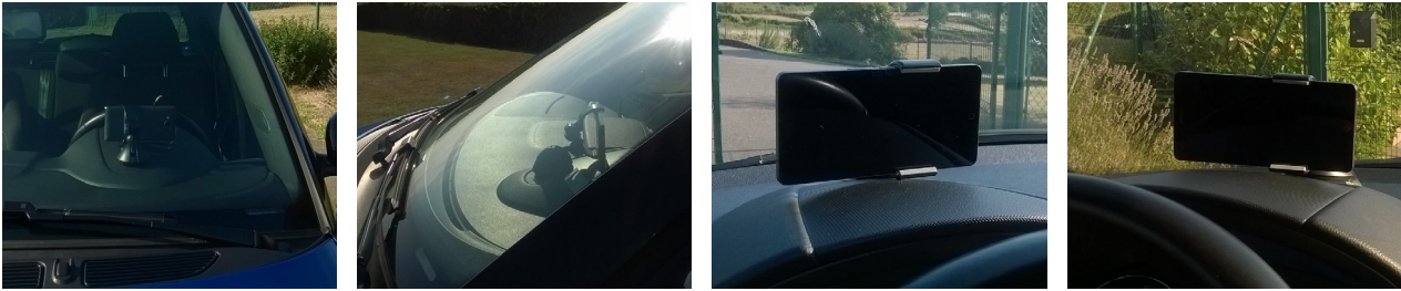
Figura 10: Posición (posición 2 - salpicadero) finalmente seleccionada para la ubicación del dispositivo móvil. De esta manera se consigue una detección facial más robusta
