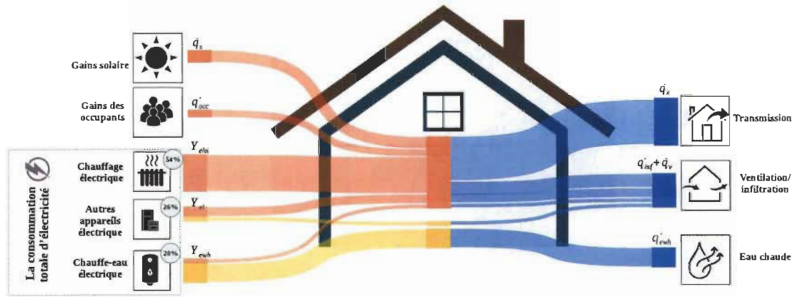
Figure. 3-2 Les flux d'énergie dans le bâtiment.
