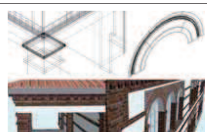
Fig.20: Proceso de elaboración de molduras y elementos decorativos de fachadas y pilares. Fuente: PFG.RLJ
