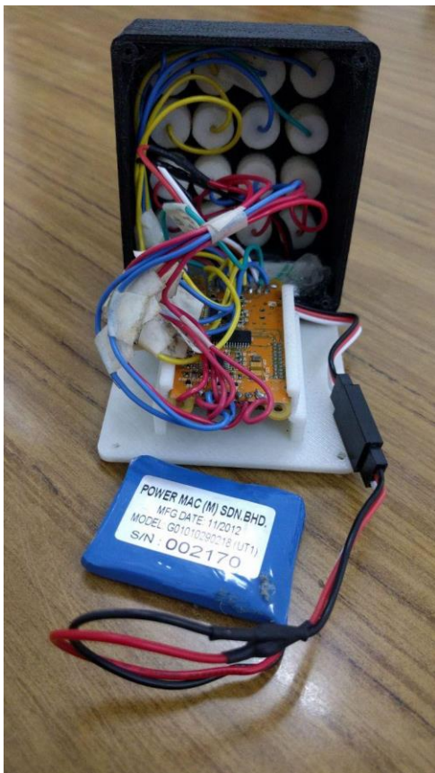
Figura 8. Placa amplificadora, bateria e conectores fixados ao suporte.
