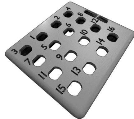
Figura 4. Vista em perspectiva dos locais onde são fixados os eletrodos.
